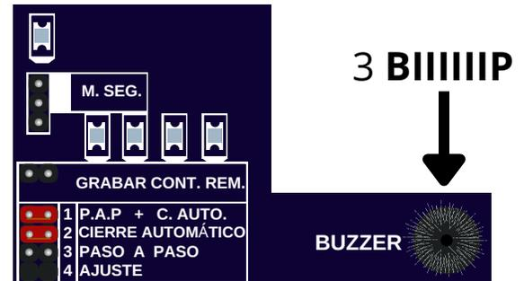
VELOCIDAD MÁXIMA - 60% DE POTENCIA (**BIIIIIP -> BIIIIIP -> BIIIIIP**).
