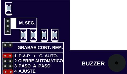
SE DEBE COLOCAR EL JUMPER EN LA POSICIÓN 1 Y EL OTRO JUMPER EN LA POSICIÓN 4, REALIZA DOS PITIDOS CORTOS Y RÁPIDOS (BIP BIP).
