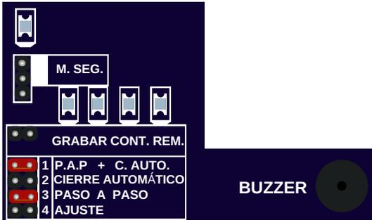
COLOCAR EL JUMPER EN LA POSICIÓN 1.
