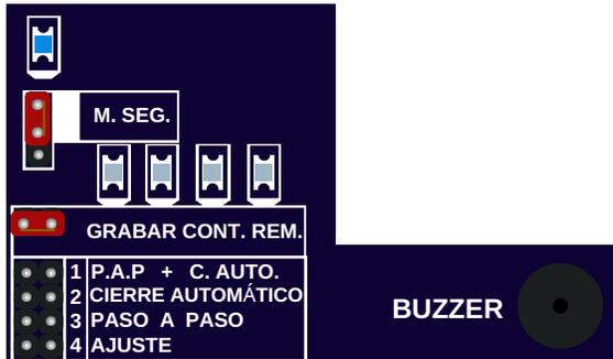
MOVER EL JUMPER DE **AJUSTE** A **GRABAR CONTROL**, EL LED AZUL VA A ENCENDER FIJO .
