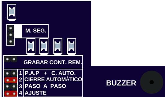
SE DEBE COLOCAR EL JUMPER EN LA POSICIÓN 2 Y EL OTRO JUMPER EN LA POSICIÓN 4, REALIZA DOS PITIDOS CORTOS Y RÁPIDOS(BLIP BLIP).
